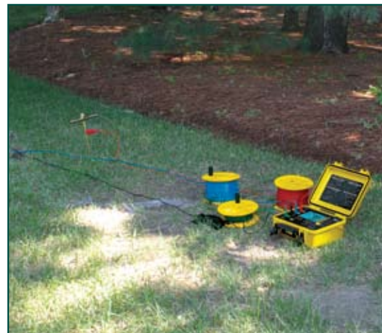
El modelo 6472 realiza una medición automática del valor de resistencia de tierra usando el método de la caída de potencial y almacenamiento de mediciones.
